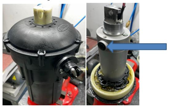
2/ Die Motorkohlen befinden sich unter Plastikkappen, die Kammer mit einem feinen Schleifpapier reinigen und den freien Lauf prüfen, mit elektrisch leitfähiger Vaseline oder einem Spray schmieren.
